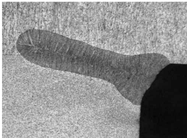
图 3.4：激光焊缝的横截面图像
