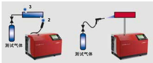
图 7.6: 使用吸枪和真空方法的局部泄漏检测
