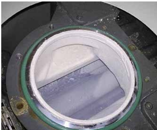
图 4.10：在温度过低的罗茨泵中六氟硅酸铵 (\text{NH}_4)_2\text{SiF}_6 的冷凝
