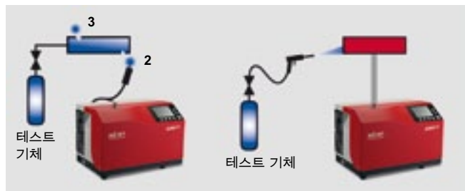
그림 7.6: 스니핑 방식과 진공 방식을 사용한 국부 누출 감지
