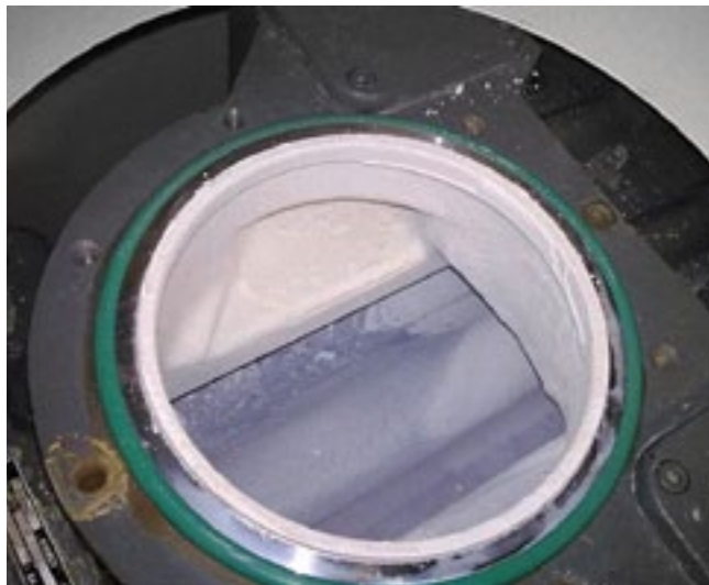
그림 4.10: 무척 낮은 온도에서 작동되는 루츠 펌프의 암모늄 헥사 플루오르 (NH_4)_2SiF_6 의 응축
