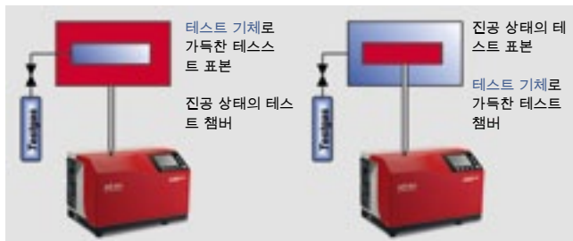
그림 7.7: 진공 방식을 사용한 전체 누출 감지
