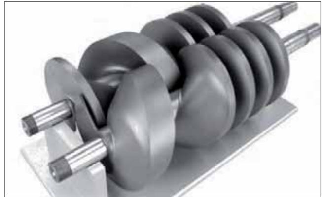
Abbildung 4.7: Rotoren der HeptaDry
