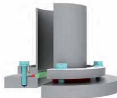
Abbildung 3.12: ISO-K-Flansch montiert auf Grundplatte mit Zentrirring, Überwurfflansch und Schrauben
