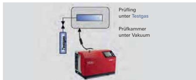
Abbildung 7.8: Integrale Lecksuche mit der Schnüffelhüllenmethode
