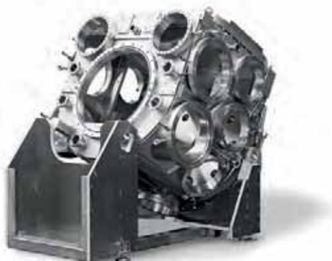
Abbildung 3.17: EUV-Quellenkammer mit Kühlprofilen und wassergekühlten Flanschen
