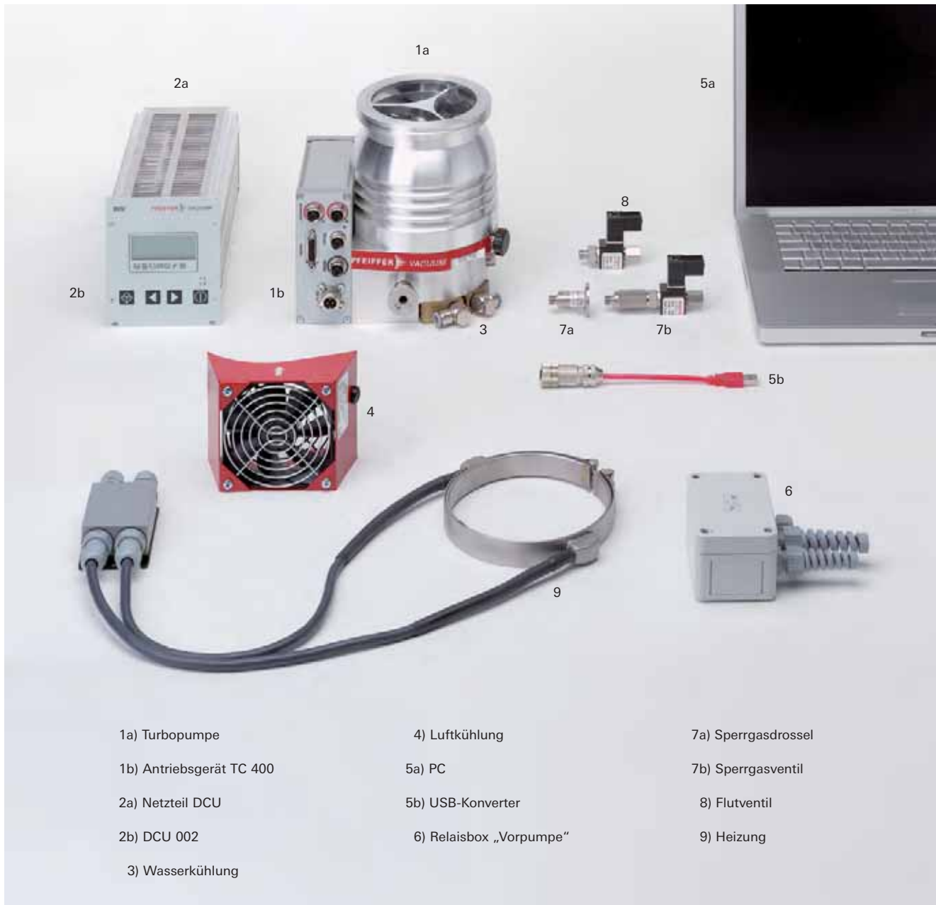
Abbildung 4.31: Zubehör für Turbopumpen am Beispiel der HiPace 300
