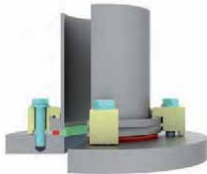
Abbildung 3.10: ISO-K-Flansch montiert auf Grundplatte mit Zentrirring und Pratten
