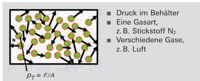
Abbildung 1.2: Definition des Totaldrucks
