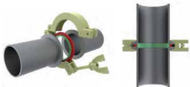
Abbildung 3.7: ISO-KF-Verbindung mit Zentrierring und Spanning
