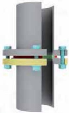
Abbildung 3.14: ISO-K-Flansch mit Überwurfflansch montiert an ISO-K-Flansch mit Zentrierung und Schrauben
