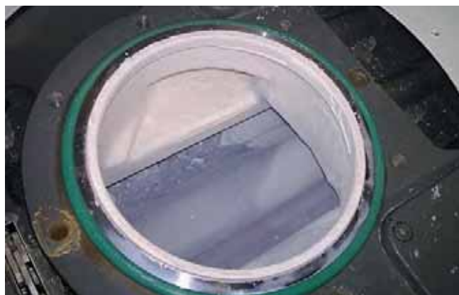
Abbildung 4.10: Kondensation von Ammoniumhexafluorsilicat (\text{NH}_4)_2\text{SiF}_6 in einer zu kalt gefahrenen Rootspumpe
