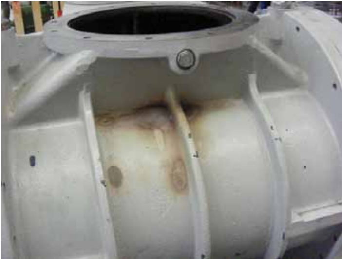
图 1 和图 2：罗茨泵因切换到极限压力而停止转动和由此产生的局部过热
