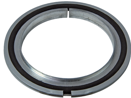
Abbildung 6: Zentrierringe mit Außen-Stützring für ISO-K-Verbindungen sind geschlitzt und ermöglichen eine Entlüftung
