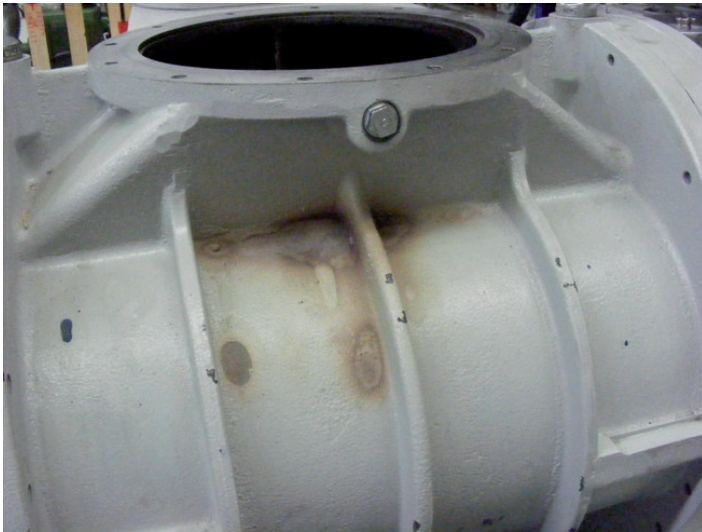
Abbildung 1: Angelaufene Wälzkolbenpumpe durch Umschaltung auf Endvakuum und resultierende örtliche Überhitzung
