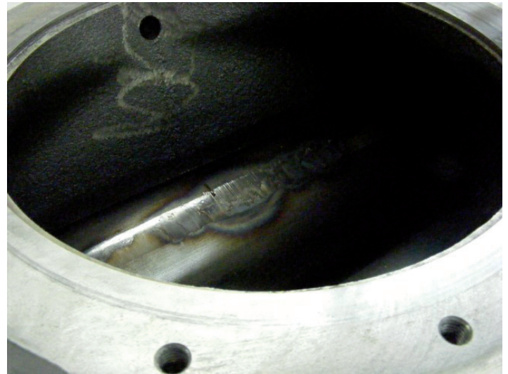
Abbildung 1: Angelaufene Wälzkolbenpumpe durch Umschaltung auf Endvakuum und resultierende örtliche Überhitzung
