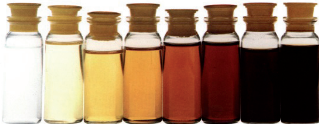
Abbildung 2: Farbskala der Betriebsmittelalterung von Mineralöl
