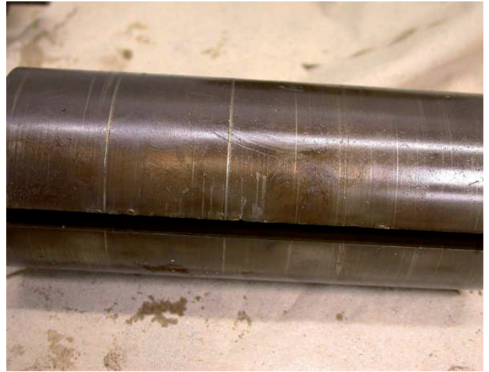
Abbildung 3 und 4: Ansaugstutzen einer Drehschieberpumpe ohne Staubfilter. Der Rotor lief im Zylinder an. Das Pumpsystem muss ersetzt werden.
