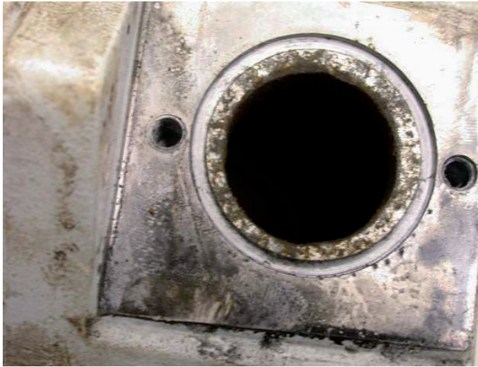
Abbildung 3 und 4: Ansaugstutzen einer Drehschieberpumpe ohne Staubfilter. Der Rotor lief im Zylinder an. Das Pumpsystem muss ersetzt werden.
